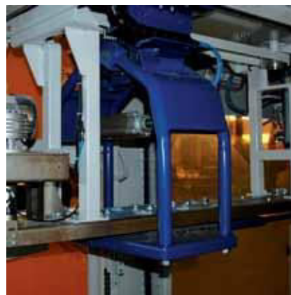
Перемещающие рычаги для транспортировки наполненного мешка до ременного направляющего конвейера
